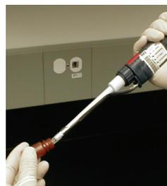
6. Coloque o tubo no sistema CELLTRACKS® AUTOPREP® quando o software o solicitar.
