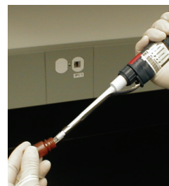
Die restliche Flüssigkeit aus der Flasche und dem Deckel pipettieren.
